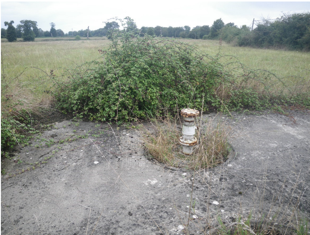
Figure 11 - Tête du forage de reconnaissance géologique du projet CINERGY (source : BRGM)
