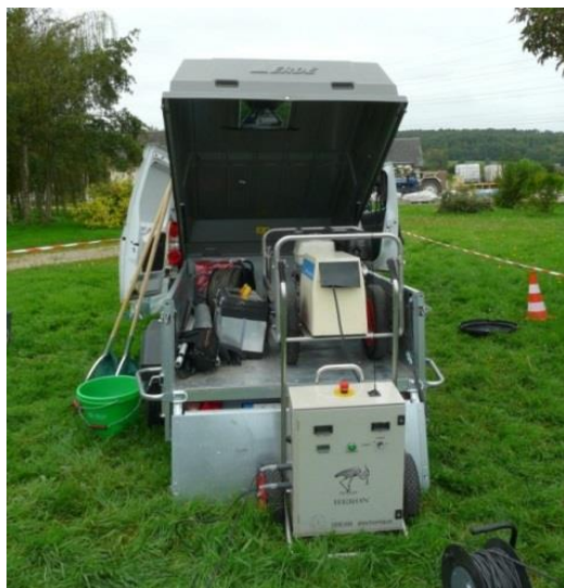
Matériel de pêche électrique de type « HERON »
