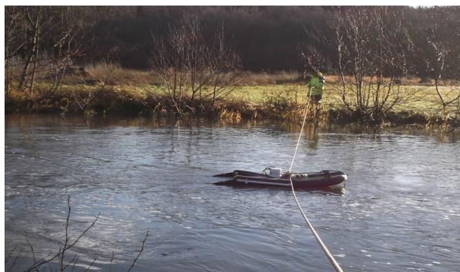
Photo n°5 : Exemple d'un jaugeage avec un profileur ADCP Surveyor
