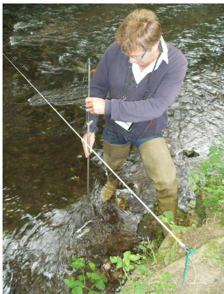
Photo n°4 : Exemple d'un jaugeage au moulinet sur la Risle à Rai
