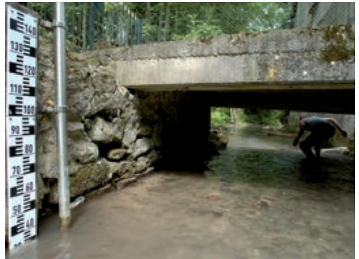
Contrôle de l'état des cours d'eau, échelle limnométrique
