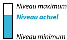
La situation des nappes est symbolisée par un indicateur représentant la position du niveau actuel de la nappe (en décembre 2014) par rapport aux niveaux minimum et maximum mesurés sur l'ouvrage depuis le début de son suivi (jauge comprise entre 0 et 100).
